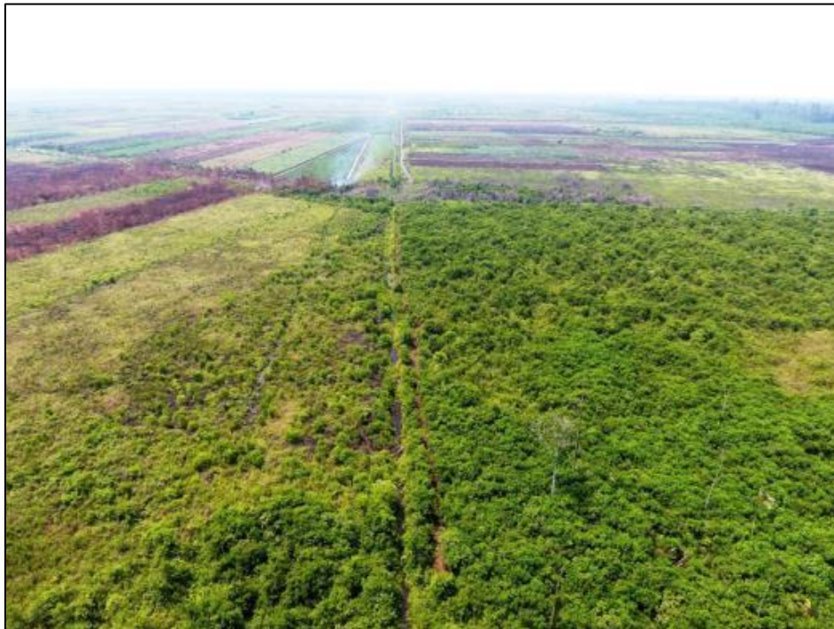
Rajah 2.1 : Bekas parit yang telah dibina dalam HSKLU dan masih aktif dalam penyaliran keluar air
