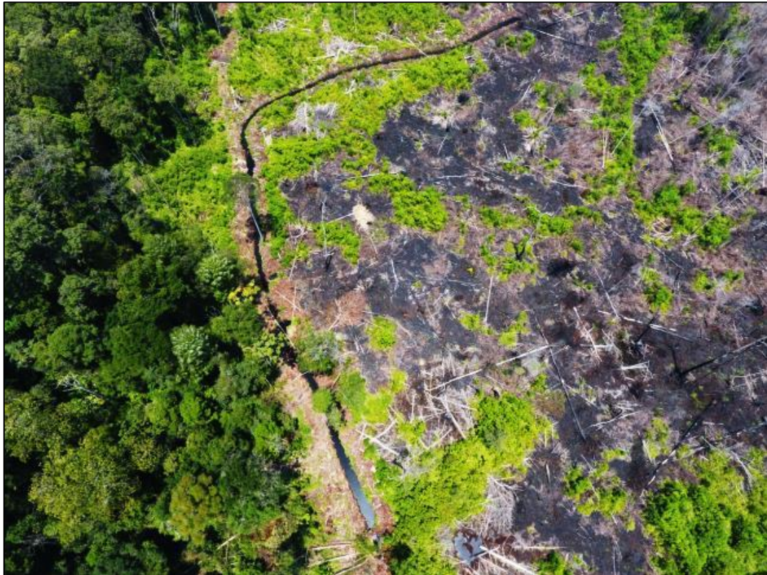
Rajah 2.4 : Pembinaan parit pemisah api untuk mengawal kemerebakan kebakaran hutan
